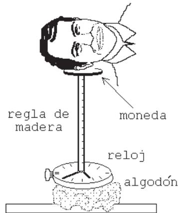
Figura 1.4: Propagación del sonido a través de una regla de madera.
